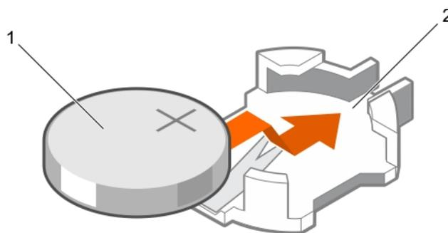
**Figure 52. Installation de la pile du système**
