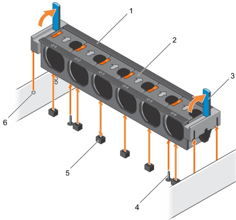
**Figure 20. Retrait de l'assemblage de ventilation**
