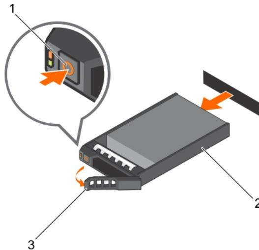
Figure 15. Retrait d'un disque dur ou SSD remplaçable à chaud
