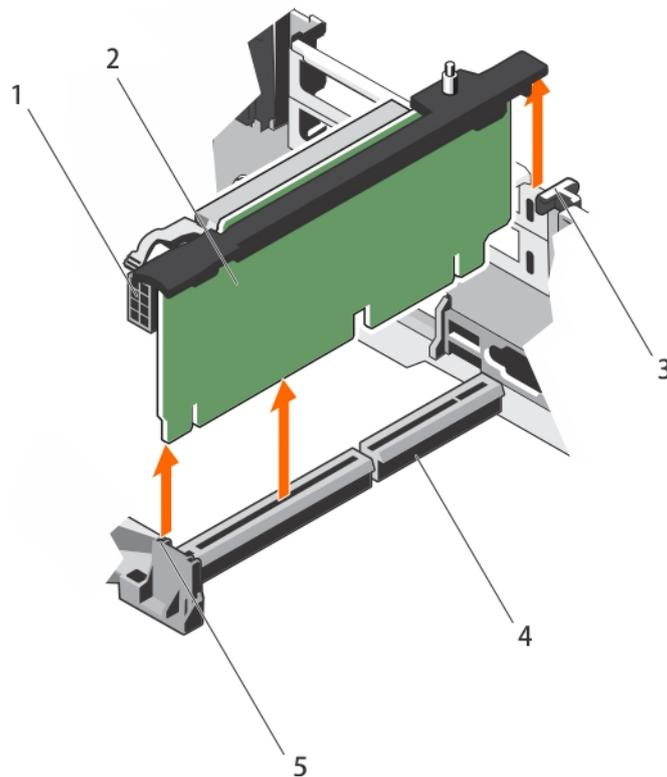
**Figure 29. Retrait et installation de la carte de montage pour carte d'extension 2**
