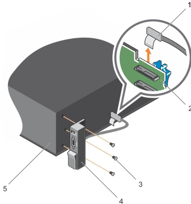
**Figure 58. Retrait et installation du panneau d'E/S - NX3230**
