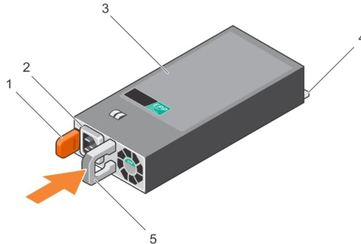
**Figure 48. Installation d'un bloc d'alimentation (PSU) CA**
