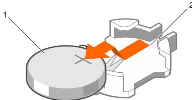
**Figure 51. Retrait de la pile du système**
