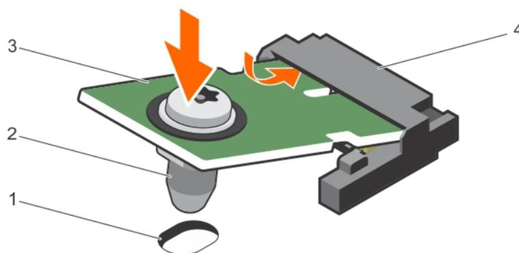
Figure 60. Installation du TPM
