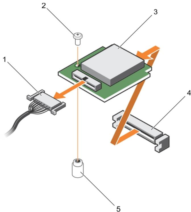
**Figure 35. Retrait et installation de l'unité de support vFlash**
