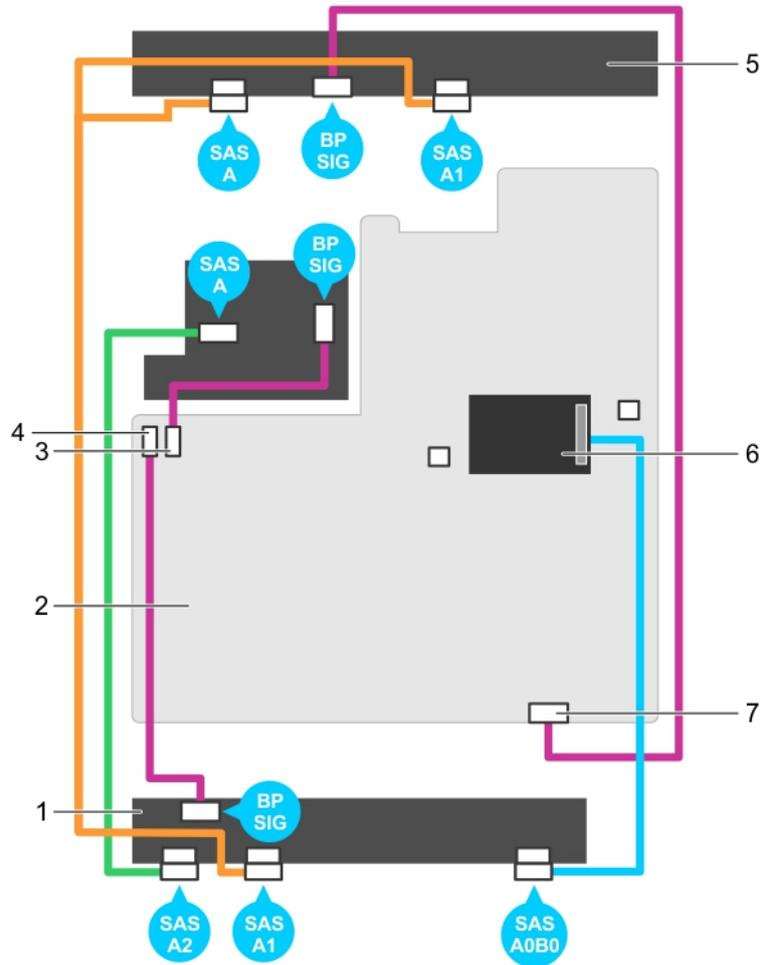
**Figure 55. Schéma de câblage : fond de panier SAS/SATA (x12) de 3,5 pouces - NX3230 (option 2)**
