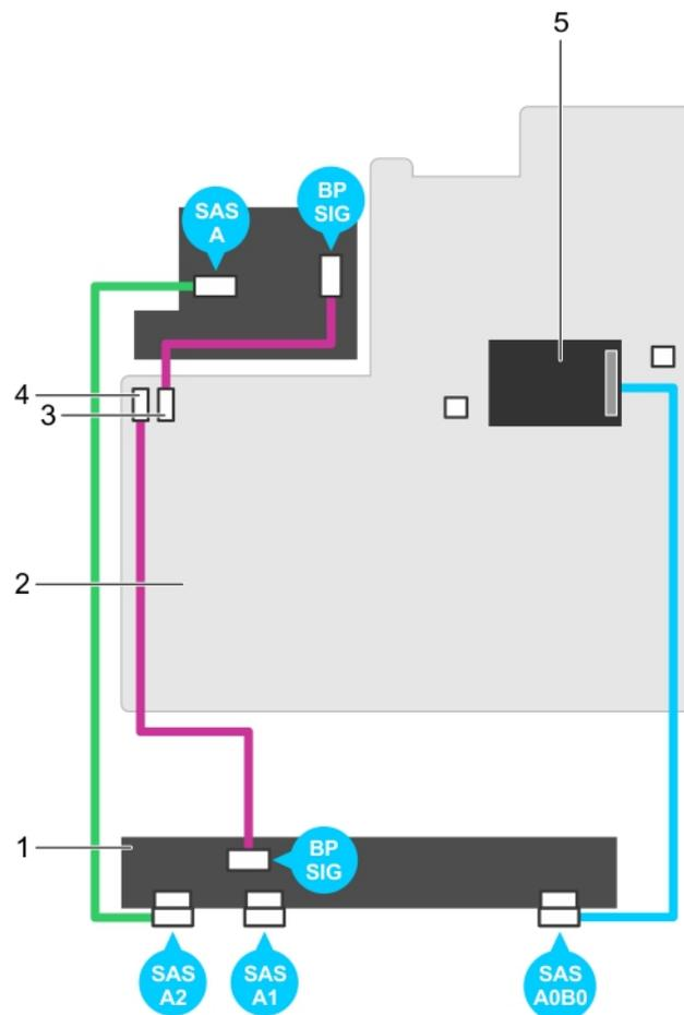
**Figure 54. Schéma de câblage : fond de panier SAS/SATA (x12) de 3,5 pouces — NX3230 (option 1)**
