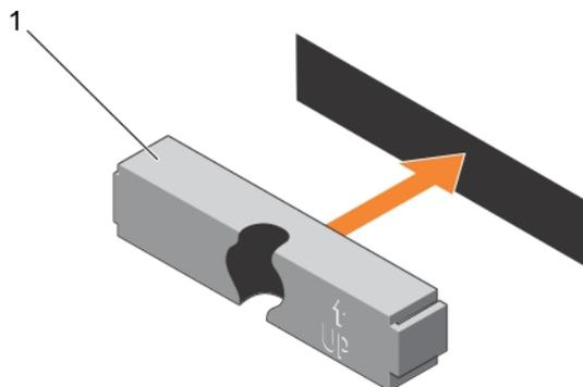
**Figure 14. Installation d'un cache de disque dur de 2,5 pouces (arrière)**
