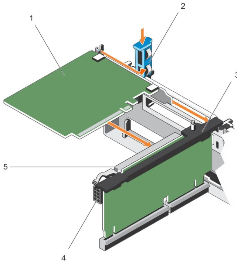
**Figure 23. Installation d'une carte d'extension dans la carte de montage pour carte d'extension 2 ou 3**
