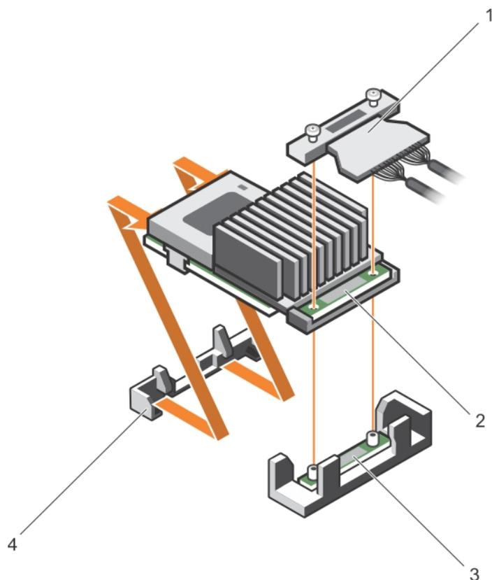
**Figure 36. Retrait et installation d'une carte contrôleur de stockage intégrée**
