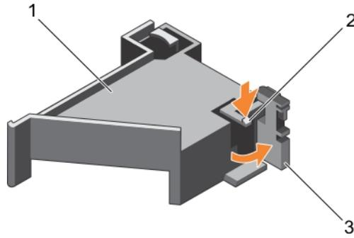
**Figure 43. Ouverture et fermeture du loquet du support de carte PCIe**
