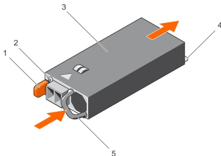
Figure 50. Installation d'un bloc d'alimentation en CC
