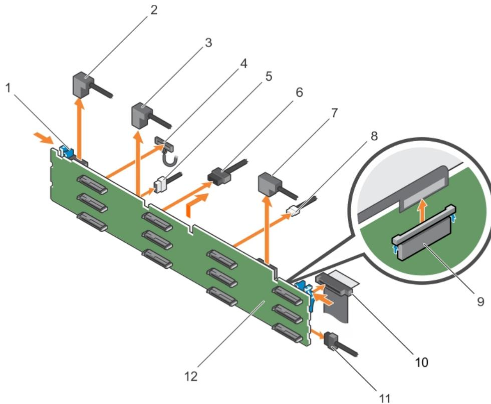
**Figure 53. Retrait et installation du fond de panier SAS/SATA (x12) de 3,5 pouces - NX3230**
