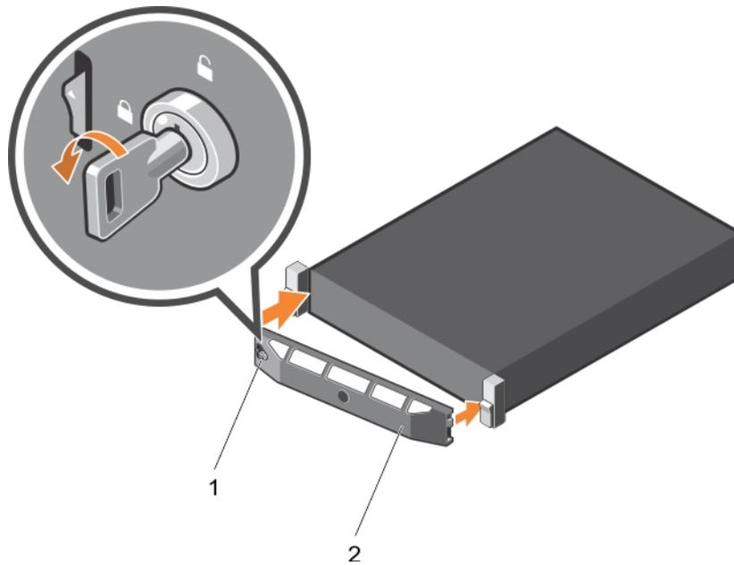
Figure 7. Retrait et installation du cadre avant
