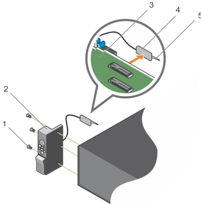
**Figure 57. Retrait et installation du panneau de commande - NX3230**
