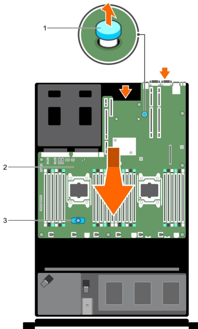
**Figure 59. Retrait et installation de la carte système**
