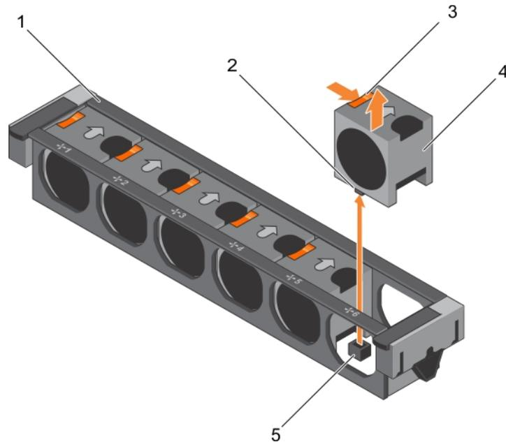
**Figure 19. Retrait et installation d'un ventilateur de refroidissement**
