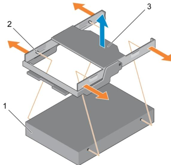
**Figure 18. Retrait et installation d'un disque dur dans son support**
