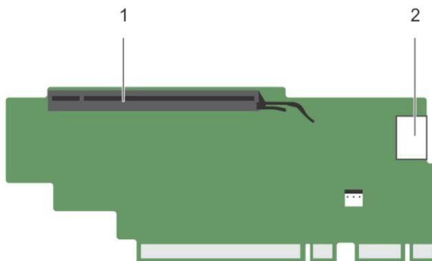
**Figure 33. Identification des connecteurs de la carte de montage pour carte d'extension 3 (alternative).**
