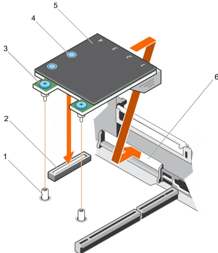
**Figure 38. Installation de la carte fille réseau**
