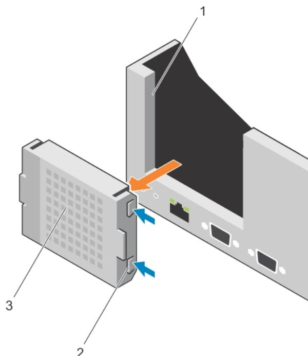
**Figure 26. Retrait et installation du cache de la carte de montage 1**
