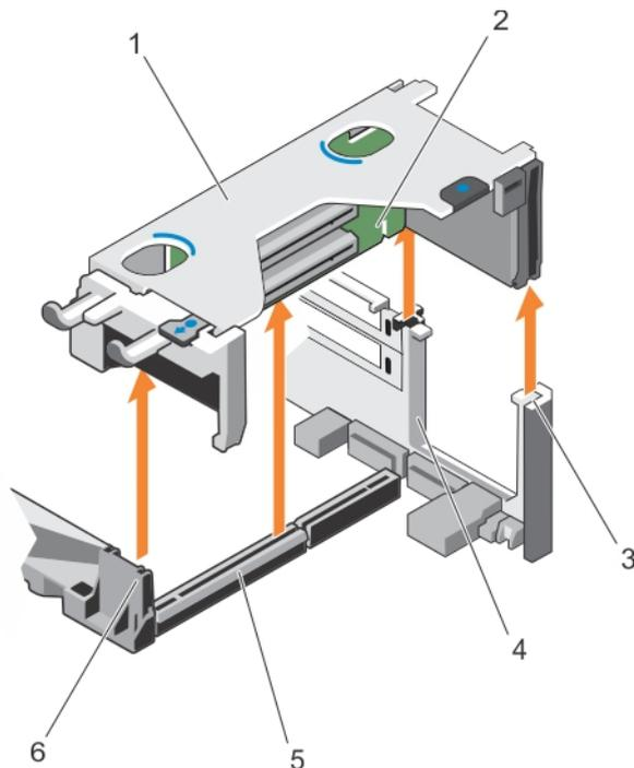
**Figure 27. Retrait et installation de la carte de montage pour carte d'extension 1**
