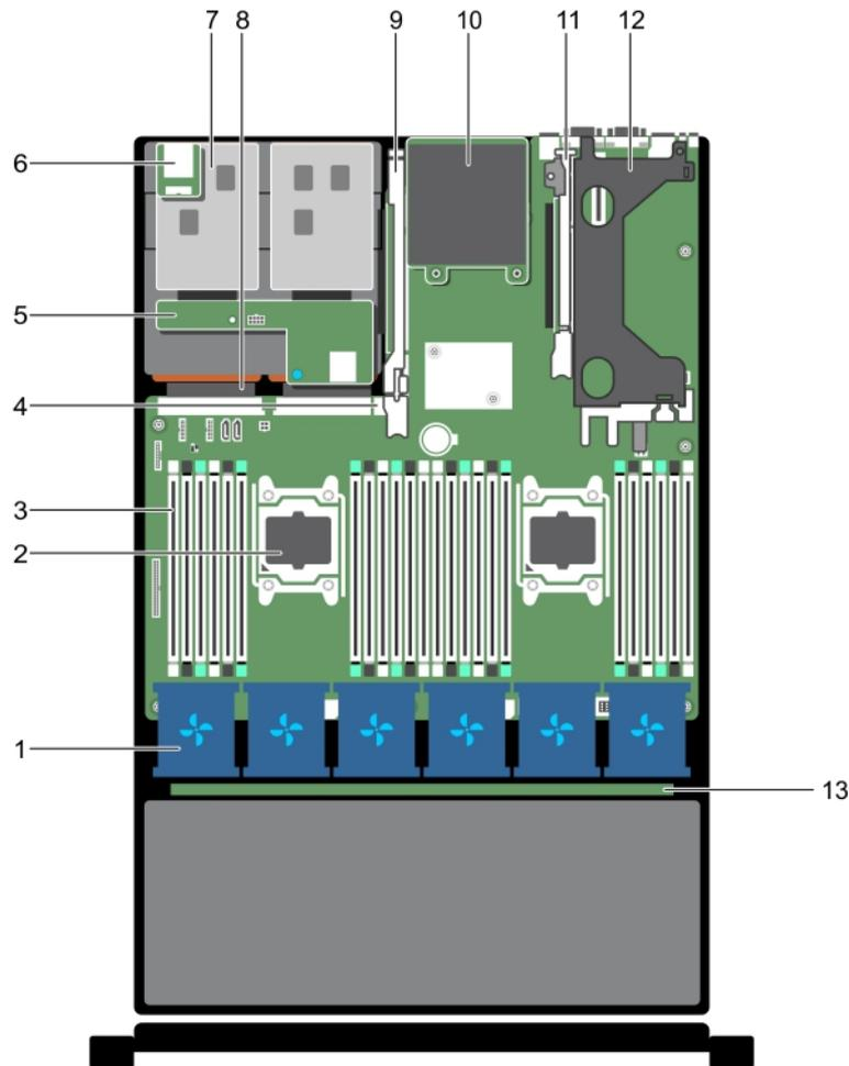
**Figure 8. À l'intérieur du système - Système à 12 disques durs**
