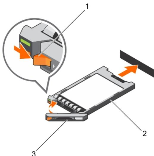
**Figure 17. Installation d'un SSD uSATA de 1,8 pouce remplaçable à chaud**
