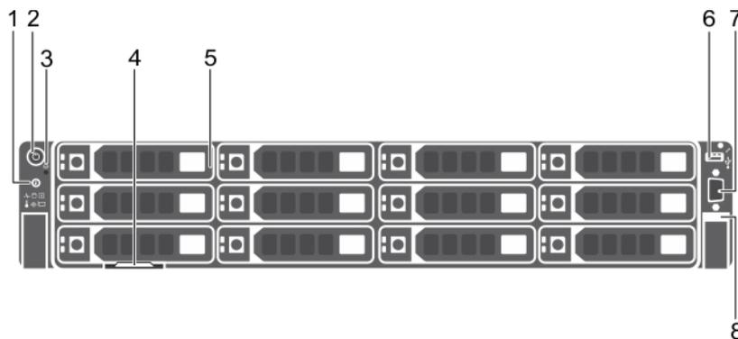
**Figure 2. Fonctions et voyants du panneau avant (boîtier de 12 disques durs de 3,5 pouces)**
