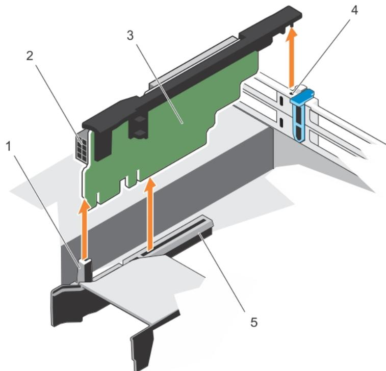
**Figure 31. Retrait et installation de la carte de montage pour carte d'extension 3**
