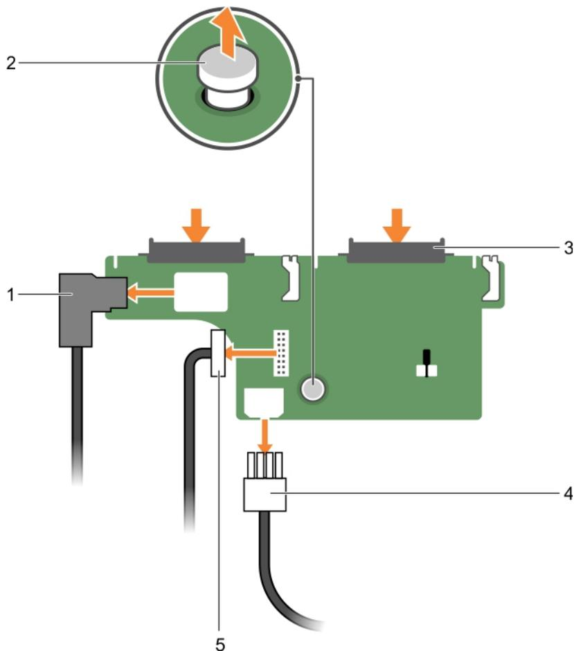
**Figure 56. Retrait et installation du fond de panier de disque dur de 2,5 pouces (x2) - NX3230**
