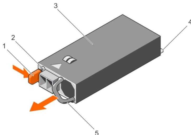
**Figure 49. Retrait d'un bloc d'alimentation en CC**
