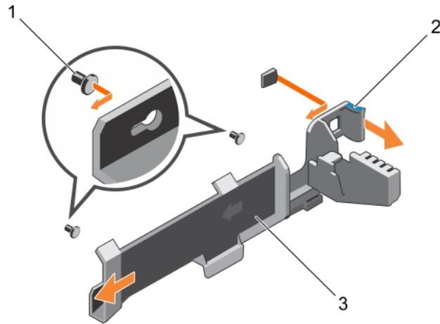
**Figure 44. Retrait et installation du support de fixation des câbles**
