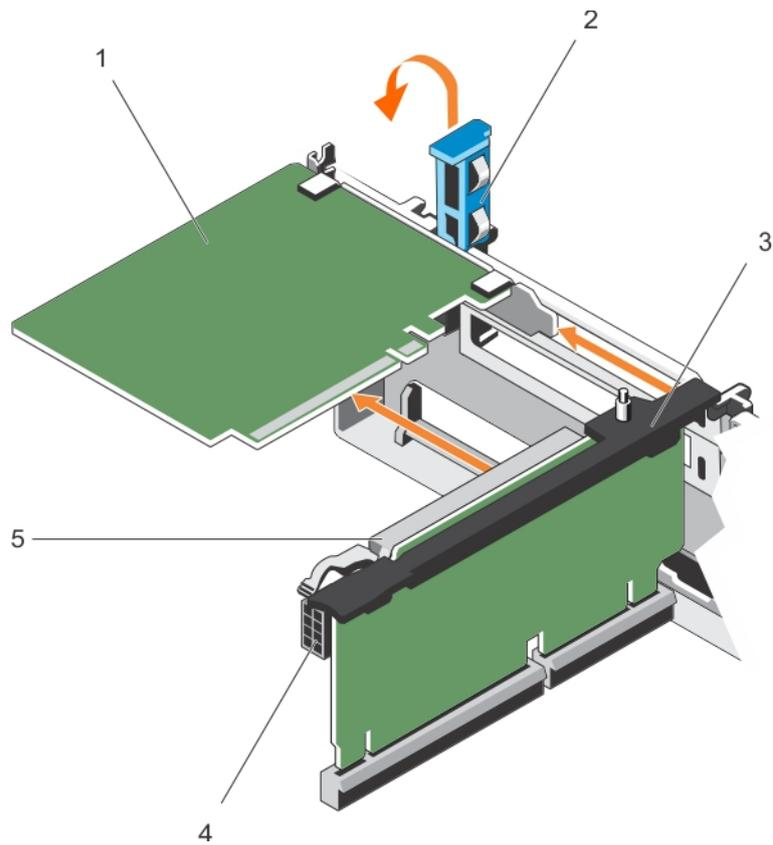
**Figure 22. Retrait d'une carte d'extension dans la carte de montage pour cartes d'extension 2 ou 3**
