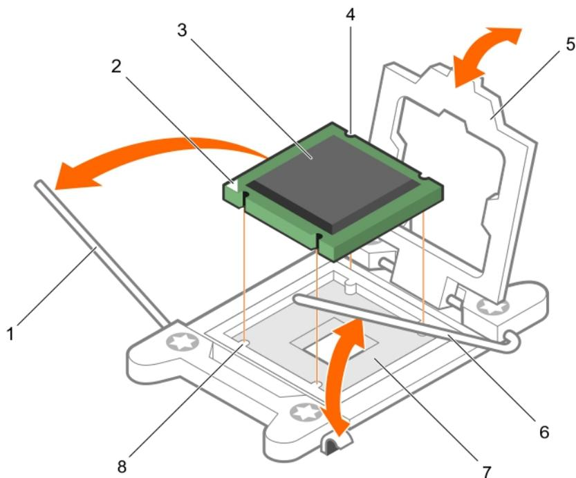
**Figure 41. Installation d'un processeur**
