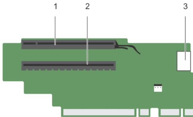
**Figure 32. Identification des connecteurs de la carte de montage pour carte d'extension 3 (par défaut)**
