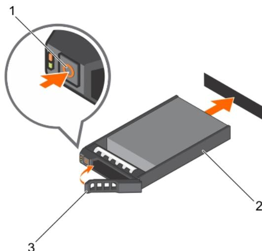
**Figure 16. Installation d'un disque dur remplaçable à chaud**
