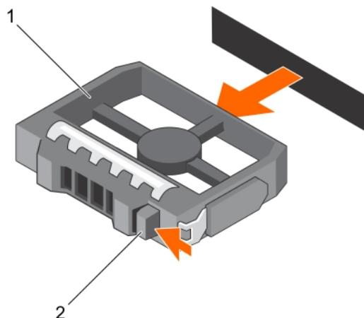
Figure 11. Retrait d'un cache de disque dur 3,5 pouces
