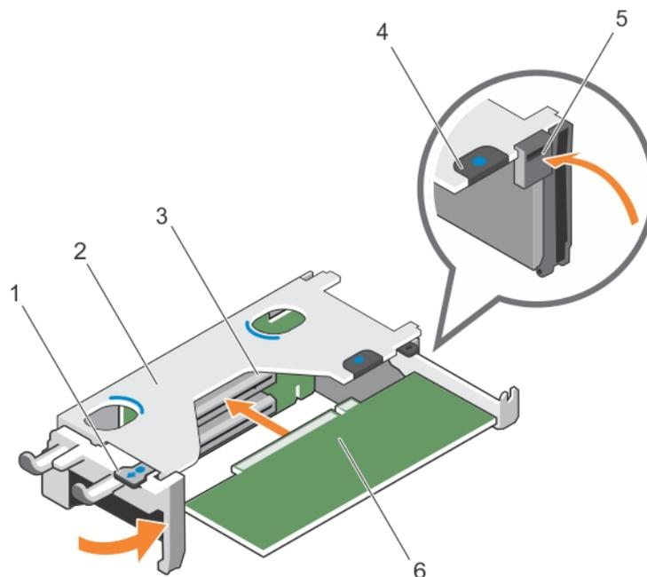
**Figure 25. Installation d'une carte d'extension dans la carte de montage 1 pour carte d'extension**
