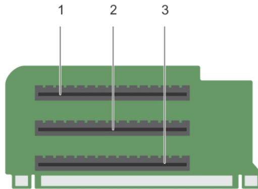
**Figure 28. Identification des connecteurs de la carte de montage pour carte d'extension 1**
