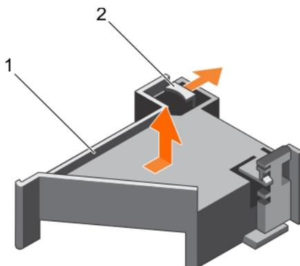
**Figure 42. Retrait et installation du support de carte PCIe**
