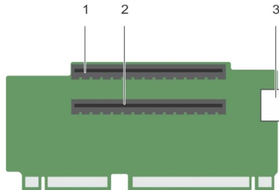
**Figure 30. Identification des connecteurs de la carte de montage pour carte d'extension 2**
