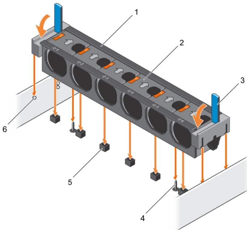
**Figure 21. Installation de l'assemblage de ventilation**
