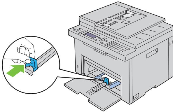
**11** Setzen Sie die Blattzufuhr (PSI) in den Drucker ein, und richten Sie sie an der Markierung des Papierfachs aus.
