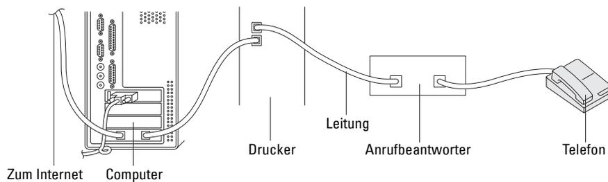
Wenn Sie das Modem Ihres Computers verwenden möchten, um Faxdokumente zu senden oder DFÜ-Verbindungen mit dem Internet aufzubauen, schließen Sie das Computermodem mit dem Anrufbeantworter direkt an der Rückseite des Druckers an den Drucker an, wie oben gezeigt.
