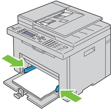
9 Schieben Sie die Längsführungen in Richtung Drucker, bis sie die Druckmedien berühren.
