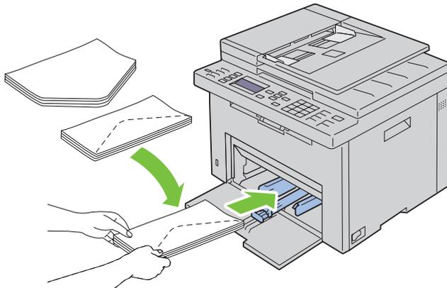
Um ein Verknicen der Umschlagformate DL und Monarch zu vermeiden, wird empfohlen, diese Umschläge mit der zu bedruckenden Seite nach oben und geöffnet, zum Bediener hin gerichteter Umschlagklappe einzulegen.
