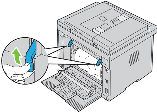
3 Entfernen Sie gestautes Papier vollständig aus dem hinteren Druckerbereich.
