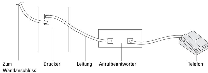
Sie können direkt an der Rückseite des Druckers einen Anrufbeantworter (AB) anschließen, wie oben gezeigt.
