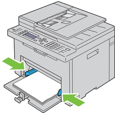
10 Schieben Sie die Längenführungen in Richtung Drucker, bis sie die Druckmedien berühren.
