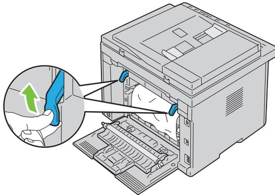
**3** Entfernen Sie gestautes Papier vollständig aus dem hinteren Druckerbereich. Wenn sich kein Papier im Papierweg befindet, überprüfen Sie das Ausgabefach im vorderen Druckerbereich.
